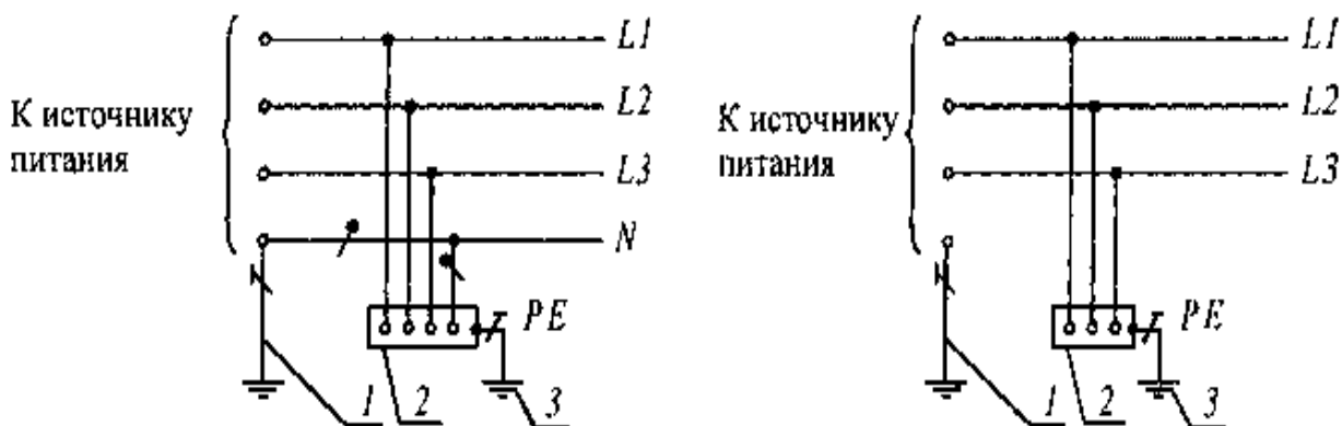
Рис. 7.1 - Система заземления ТТ переменного тока.
